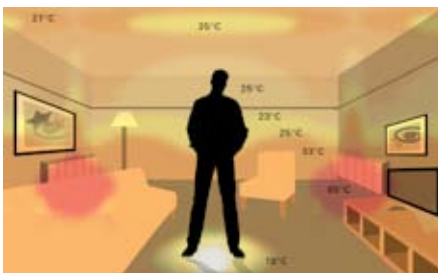
פיזור החום של מערכת חימום קונבנציונאלית עם רדיאטורים. הפרשי חום גבוהים בחדר (18-65 מעלות)
